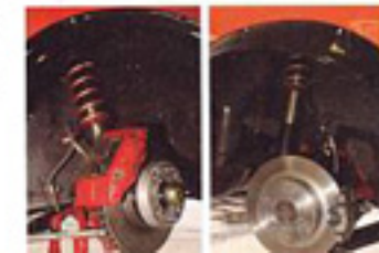
アラゴスタの特注品で固められた足回りは、当然ながら専用調整式。理想のコーナリングを求めて、まっしりとコーナーウエイトを追求できるハイクオリティパーツだ。
